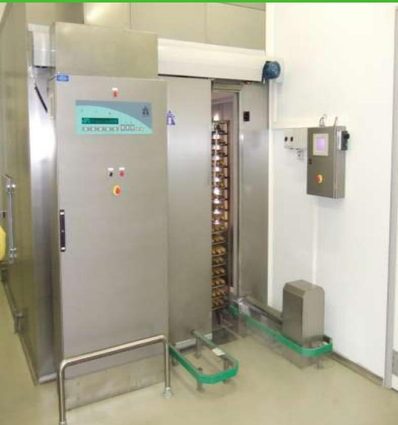
L'abbattitore-congelatore, grazie a un potente sistema di refrigerazione con aria a ca. -40°C, consente di raggiungere la temperatura di -20°C al cuore del prodotto in meno di 240 minuti mantenendo così intatte le qualità organolettiche del cibo. Dopo lo scongelamento del prodotto eseguito a temperatura controllata di +3°C in frigorifero, non avverranno perdite di liquidi, consistenza e gusto.
