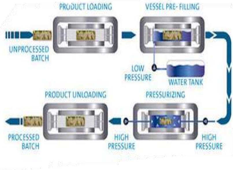
Alimenti e bevande da trattare vengono caricati preimballati all'interno di cilindri inox nella camera ad alta pressione che viene riempita con acqua.
