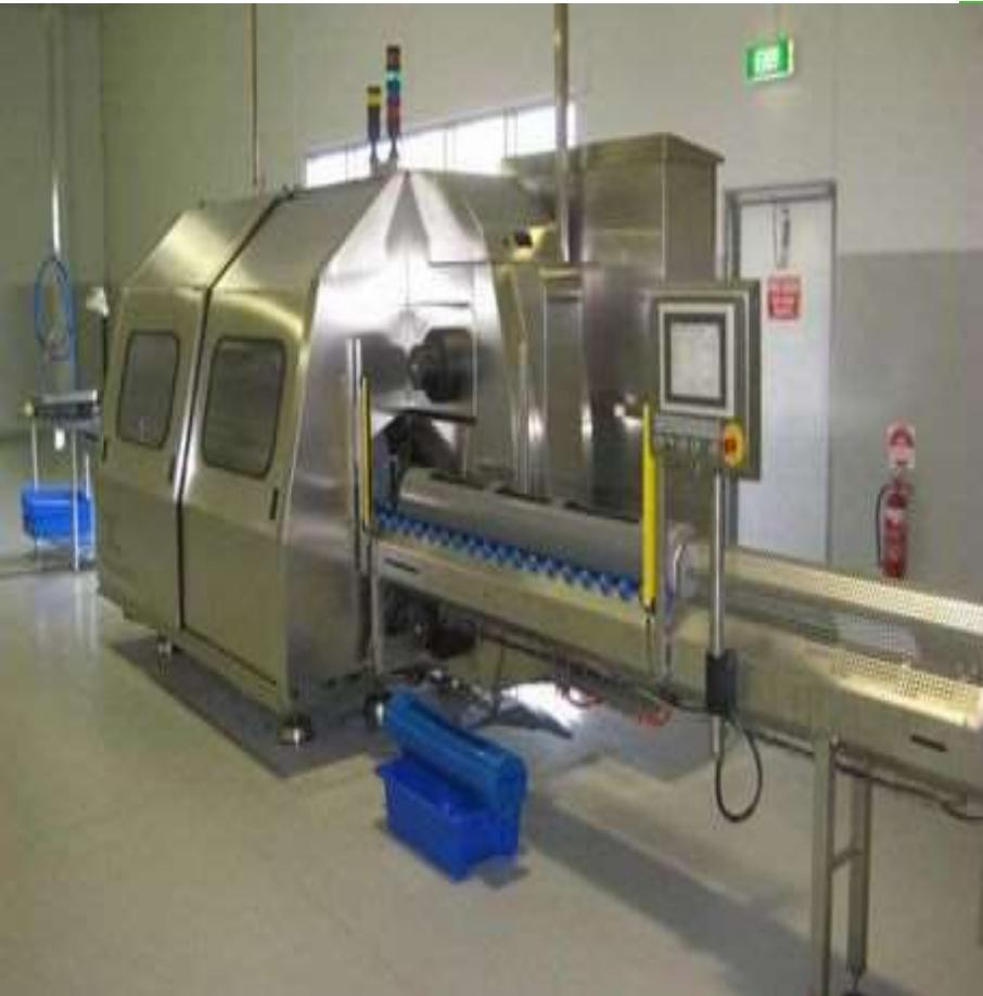
L'HPP (High Pressure Processing), è una tecnologia che utilizza elevate pressioni idrostatiche anziché alte temperature, per ottenere la «sanificazione» dei cibi.
